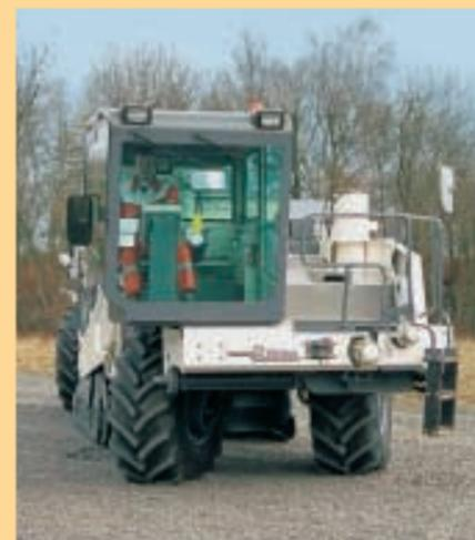
La cabina mobile consente al conducente una buona visuale del bordo di fresatura.
