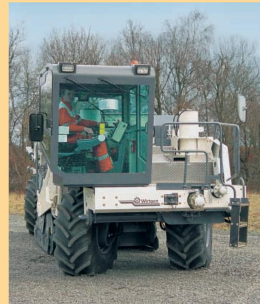
Per una visuale ottimale in avanti e indietro, la console del posto di guida, strumenti e display inclusi, può essere ruotata di 90°. Questo è vantaggioso non solo durante le manovre.
