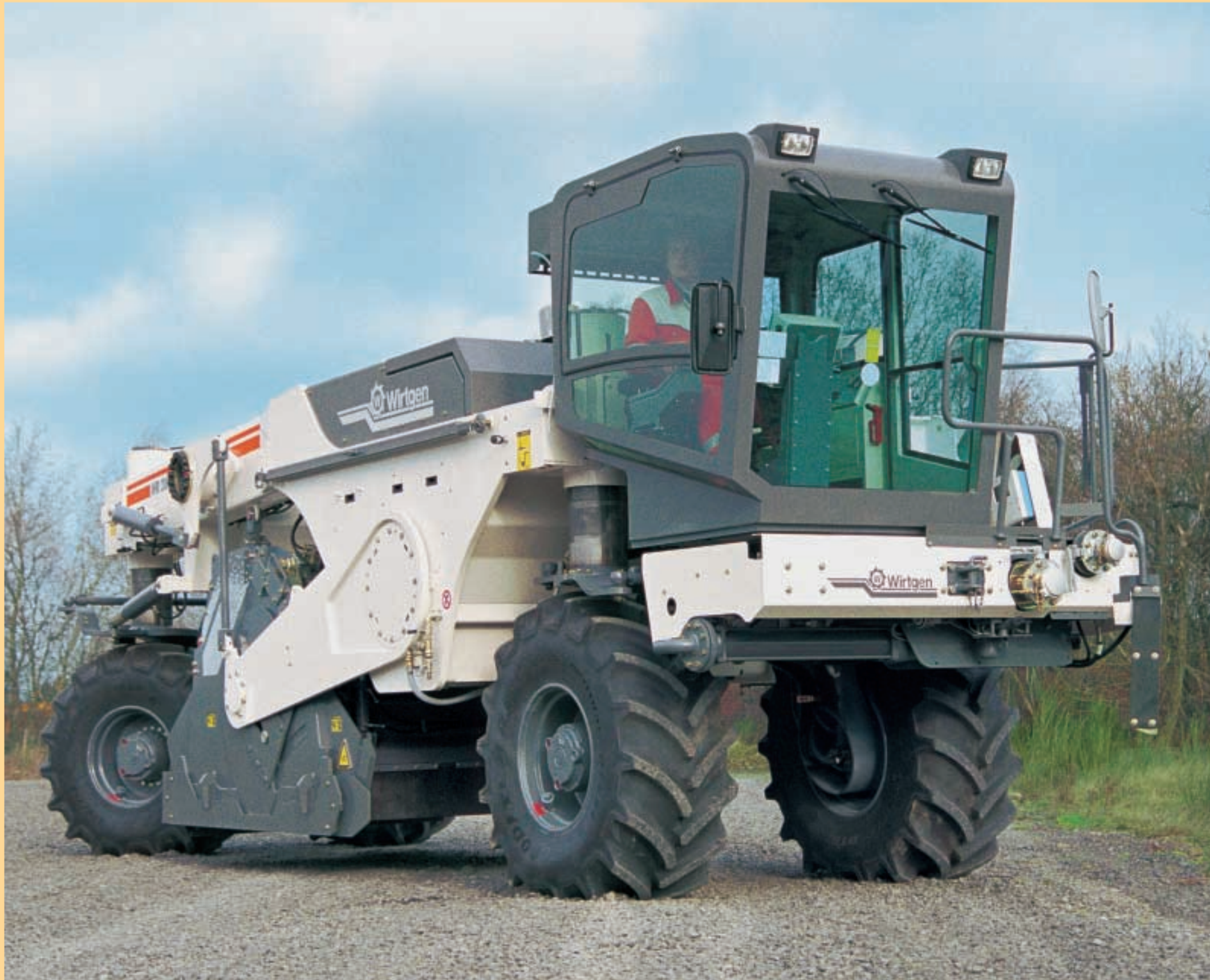
La WR 2000 lavora invece di bloccarsi. Anche su terreni molli e pesanti, grazie alla sua impressionante altezza libera dal suolo di 400 mm e alla trazione integrale l'agile riciclatrice mostra straordinarie caratteristiche di trazione. I cilindri di lavoro sono inoltre collocati in alto in modo da non sporcarsi. Anche questo
