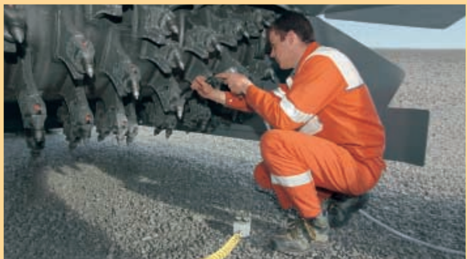
Optional utili come, p. es. l'inseritore e l'espulsore pneumatico dei denti oppure il dispositivo ruotarullo facilitano e velocizzano notevolmente la sostituzione dei denti.
