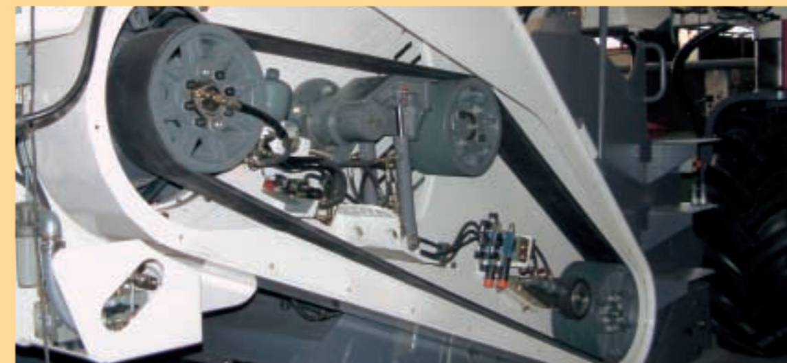
L'azionamento meccanico del rullo è noto per la grande efficienza durante la trasmissione della forza. La capacità di penetrazione viene inoltre assicurata dal ten-
