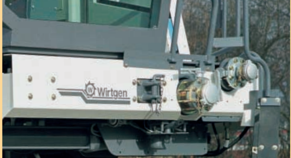
Sulla traversa anteriore si trovano gli attacchi per le condutture flessibili per il bitume e per l'acqua. Immediatamente dietro, un flussimetro misura le quantità convogliate.
