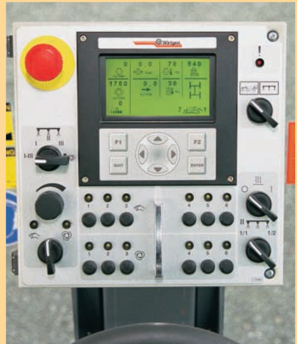
Tutte le informazioni fondamentali sull'impianto di riciclaggio a freddo vengono visualizzate chiaramente. Da qui vengono effettuate anche tutte le immissioni per l'aggiunta dei leganti.
